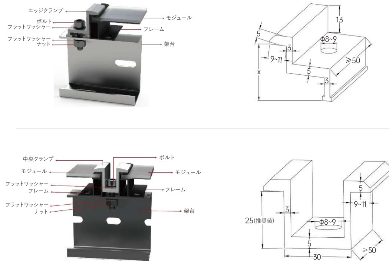
いかなる場合でも、押さえ金具をガラスに接触させないでください。また、モジュールのフレームを变形させることは厳禁されています。押さえ金具により遮光されないようにしてください。フレームの高さと押さえ金具の適合性にご注意ください。
