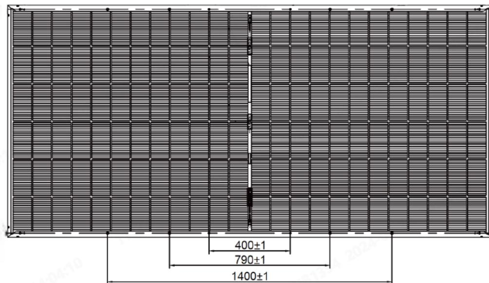
M8の締め付けトルク範囲は16~20Nmで、M6の締め付けトルク範囲は8~12Nmにしてください。ボルト仕様の選定は部品サプライヤー側の指導に従ってください。
